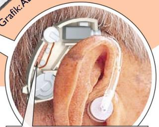
Die **Telespule** im Hörgerät nimmt das Signal aus dem magnetischen Feld auf.
